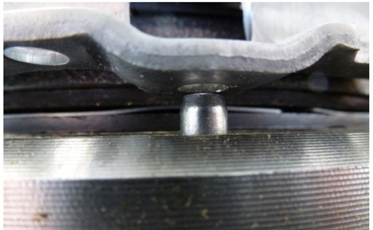
Bild 1: Die Zentrierstifte setzen sich bei der Montage nicht in die Bohrungen
