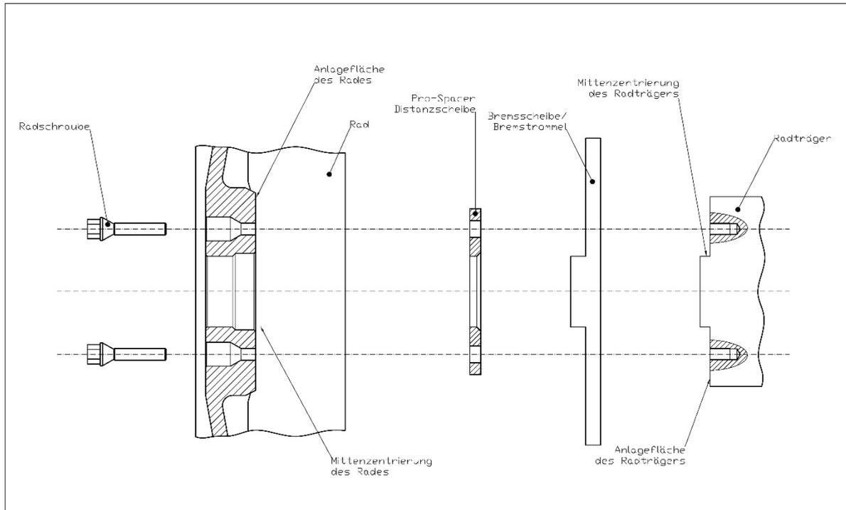
1. Die Die Mittenzentrierungen und Anlageflächen des Radträgers und des Rades (Bild 1) dürfen nicht nachträglich lackiert worden sein und müssen von Rost und Schmutz befreit und gereinigt werden. Verwenden Sie hierzu eine Drahtbürste und gehen Sie vorsichtig vor, um andere Bauteile nicht zu beschädigen.
