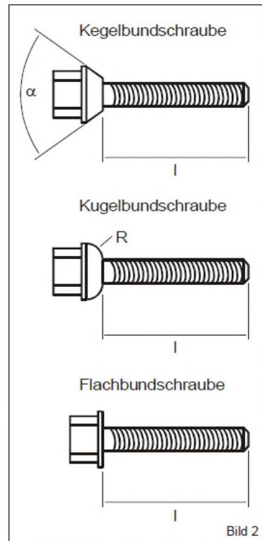
2. Bei ordnungsgemäßem, spielfreiem Sitz der Distanzringe und korrekter Schraubengröße und -form werden die **Pro-Spacer** zwischen Rad und Radträger montiert. Hierzu wird zunächst der **Pro-Spacer** Distanzring auf den Radträger aufgesteckt und anschließend das Rad auf den **Pro-Spacer** Distanzring. Die Teile werden dann durch Eibach-Spezialschrauben befestigt. Die notwendigen Anzugsmomente sind dem Werkstatthandbuch bzw. dem Gutachten des Radherstellers (bei Sonderrädern) zu entnehmen.
