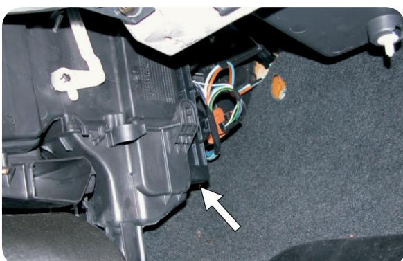
**IT** Allentare le viti che trattengono la copertura della camera filtrante
